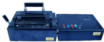
・IDE-液晶検査治具
